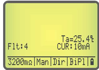
Eingestellt wird die Temperatur mithilfe der Taster ▲ und ▼ zur Erhöhung bzw. Verminderung des rechts am Display angezeigten Temperaturwerts, mit einer Auflösung von 0.1°C in einem Bereich von 0.0°C und 50.0°C. Der neue Wert wird automatisch im nichtflüchtigen Speicher abgelegt, wenn Sie zur Messung mit Temperaturkompensation umschalten.
