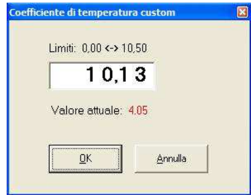
Fig. 2.7 Una delle finestre di immissione dei parametri. In caso venisse digitato un valore che deborda dai limiti consentiti viene segnalato l'errore.
