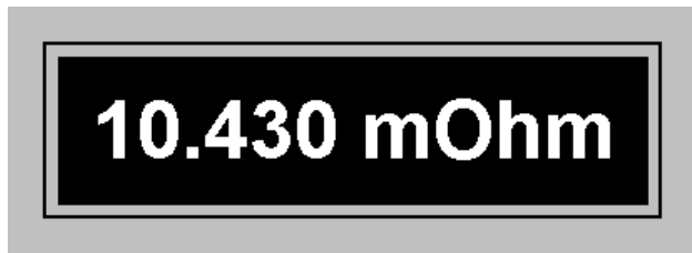
Fig. 2.12 Nel display virtuale compaiono sia la misura fornita dallo strumento che le segnalazioni relative alla validità della misura e al collegamento con lo strumento stesso.
