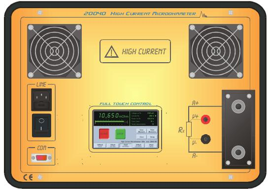
**Fig. 1** Vista del frontale dello strumento con le grate delle ventole di raffreddamento, la presa e l'interruttore di rete, la porta di comunicazione, lo smart display e le connessioni di corrente e tensione.
