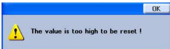
**Fig. 5** L'avviso segnala che non è possibile procedere all'azzeramento dello strumento perché il valore misurato è troppo elevato.
