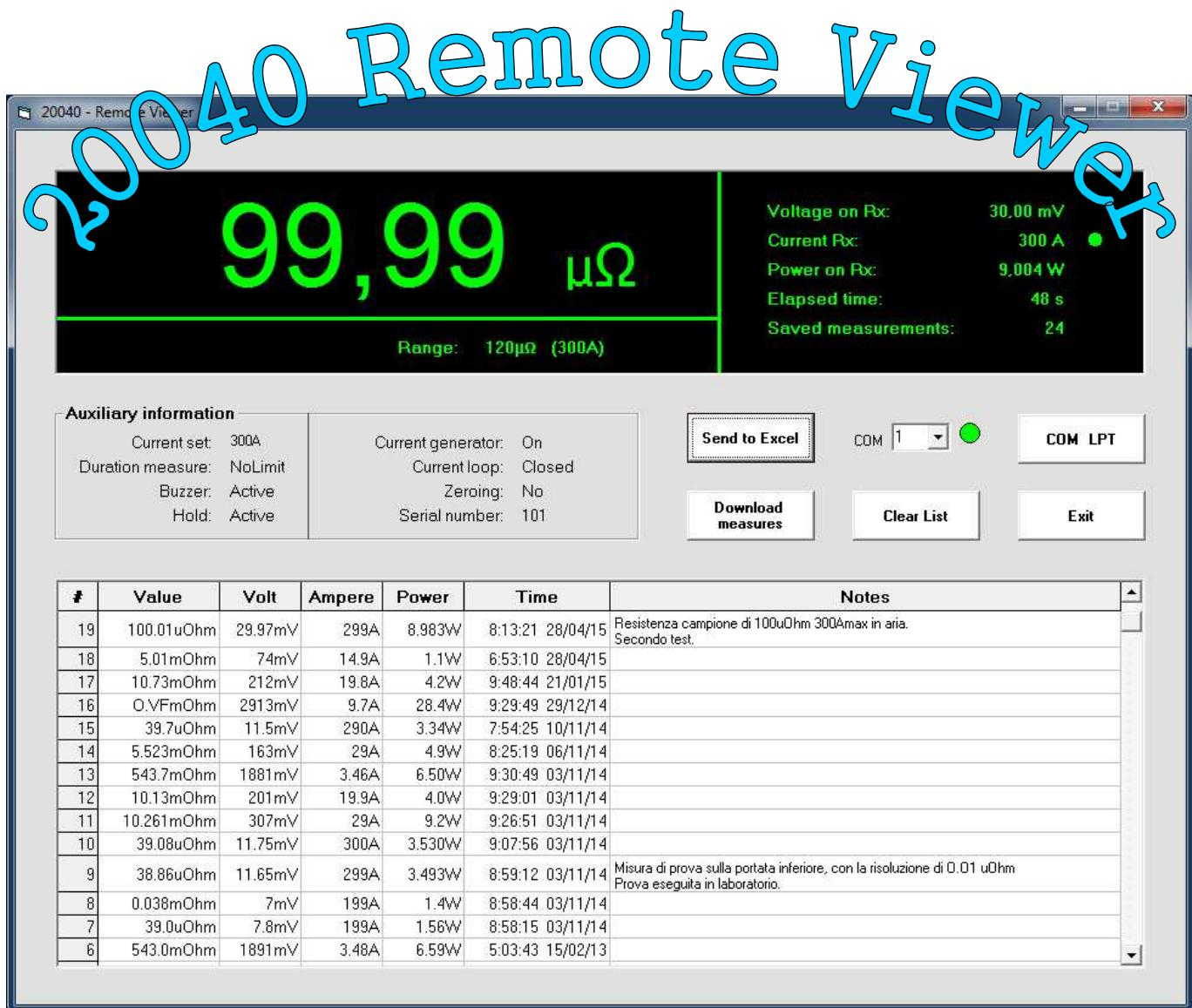
**20040 Remote Viewer** è un software in ambiente Windows che consente di visualizzare in remoto la misura di resistenza, le misure ausiliarie, le impostazioni e altre segnalazioni. Inoltre è possibile scaricare i dati salvati nella memoria non volatile dello strumento, ciascuno composto da: valore resistivo, tensione ai capi di Rx, la reale corrente che attraversa Rx, la potenza dissipata su di essa, ora e data della registrazione ed infine le note associate alle misure, ove presenti.
