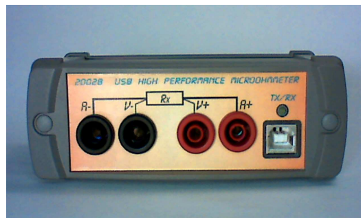
Fig. 2.1 Vista frontale del modulo con le quattro boccole per la misura Kelvin e la presa USB.
