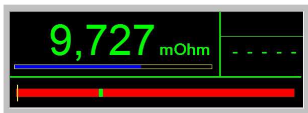
Fig. 3.12 Quando è in esecuzione la misura impulsiva compare la barra segnatempo che diventa completamente gialla a misura terminata, segnalando l'aggiornamento del display principale, ed eventualmente di quello secondario, con il nuovo valore.
