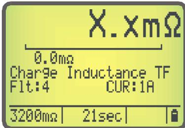
In questo esempio lo strumento sta caricando l'induttanza del trasformatore sotto misura da 21secondi.
