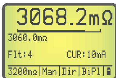
Misura principale sulla portata di 3200mΩ, in modalità misura bipolare. Filtro = 4.
