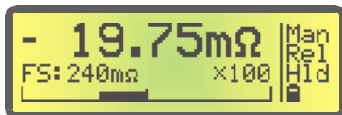
Fig. 3 Misura relativa. Si noti il bargraph che, partendo dal centro, per valori negativi si sposta verso sinistra.
