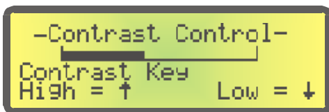
Fig. 6 Alla videata di controllo del contrasto si accede premendo brevemente il tasto PWR due volte, ovvero provenendo dal controllo della retroilluminazione.
