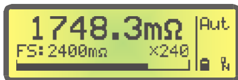
Fig. 2 Misura principale dello strumento, in modalità Automatica, sulla portata di 2400mΩ.
